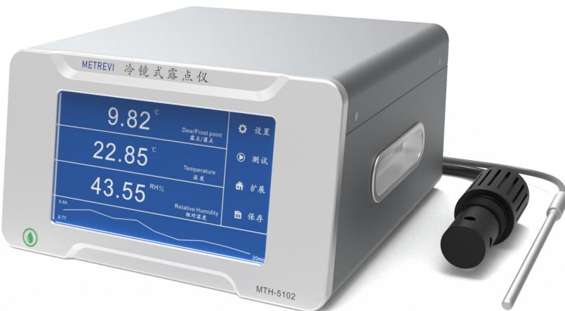
欢迎使用 MTH5102 冷镜式露点仪，其采用冷镜式原理，使用二级半导体制冷片对镜面制冷。当被测气体中的水蒸气随着镜面温度逐渐降低而达到饱和，当镜面温度低于露点值时，凝结速度高于升华速度，露层增厚；反之露层减少。当水蒸气的凝结与升华速度平衡时，镜面温度即为露点温度。
