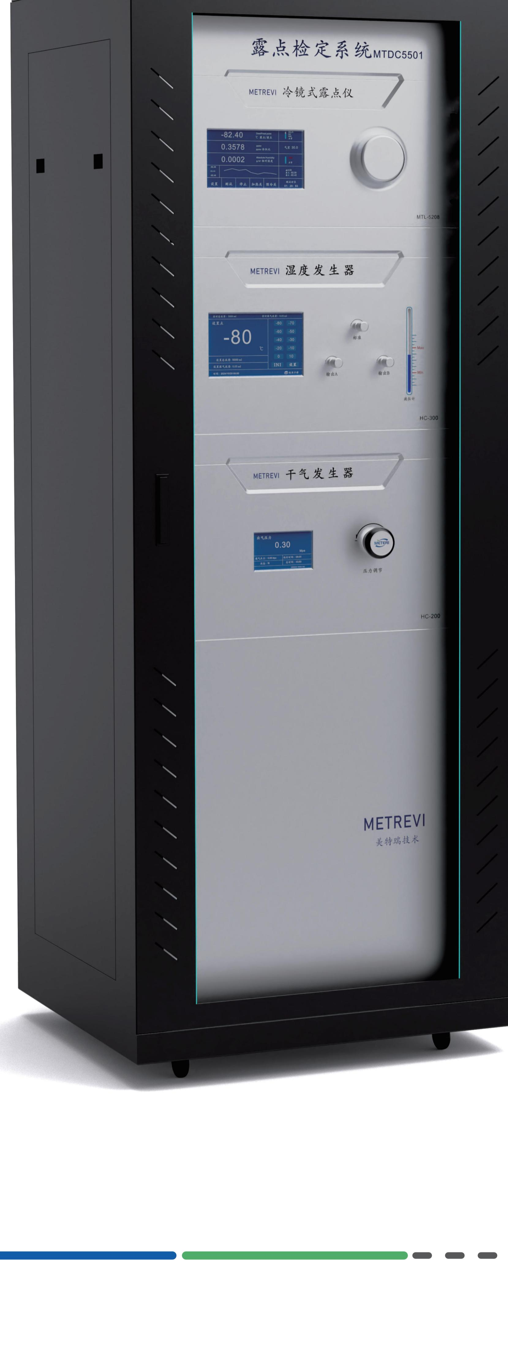
MTDC5506露点检定系统中湿度发生器生器是根据分流法原理实现湿度的调节。通过干湿气流不同的配比关系可以得到不同露点温度的气体，该方法根据实际需要可以使用多级的分流搭配，发生出想要的露点值气源。
